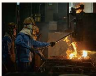
材料を溶解する温度は約1600℃。材料づくりから仕上げまでの一貫生産。
