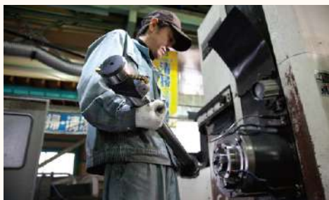
横中ぐり用の工具が多彩に揃う工場内。特注工具の製作で技術向上を図る。写真はφ195用ドリル。
