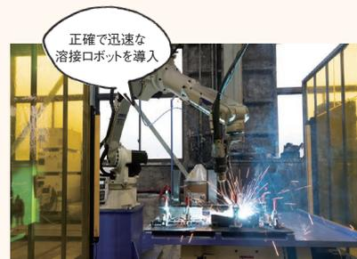
正確で迅速な溶接ロボットを導入
