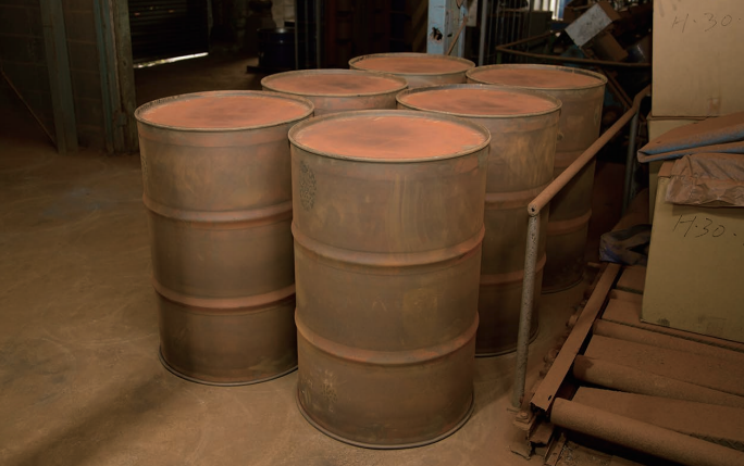
▲焼缶後にドラム缶の変形や凹みを調整し、本来の形に整形
